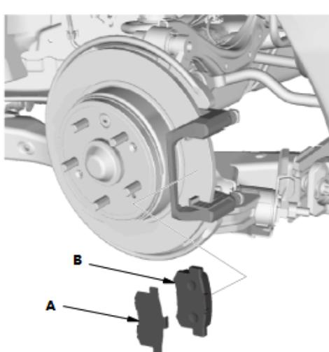
1. 拆下外制动片垫片 (A) 和外制动片 (B)。
