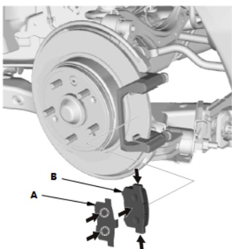
1. 将二硫化钼 M-77 润滑脂涂抹到垫片 (A) 的制动片侧、制动片 (B) 的背面以及箭头所指的其他部位。
